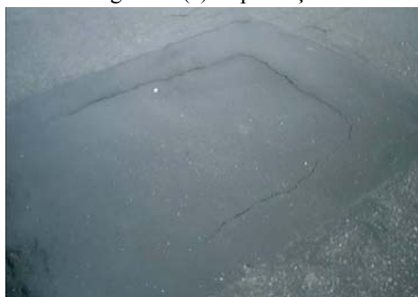
Figura 6. Defeitos ocasionados por deficiência na compactação da base.
